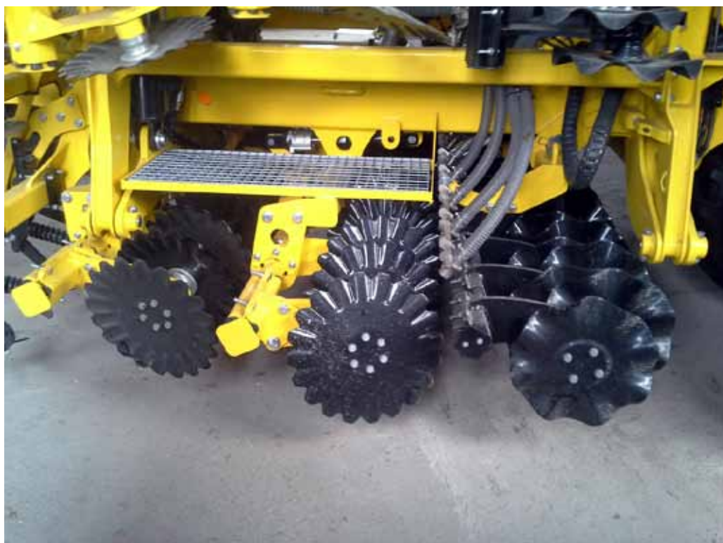
Přední talířová a střední talířová sekce (umístěny do tvaru »X«) s aplikačními trubicemi granulovaných hnojiv a zadní coulterová sekce pro variabilně nastavitelnou intenzitu předseťové přípravy půdy na secím stroji koncepce BEDNAR.
