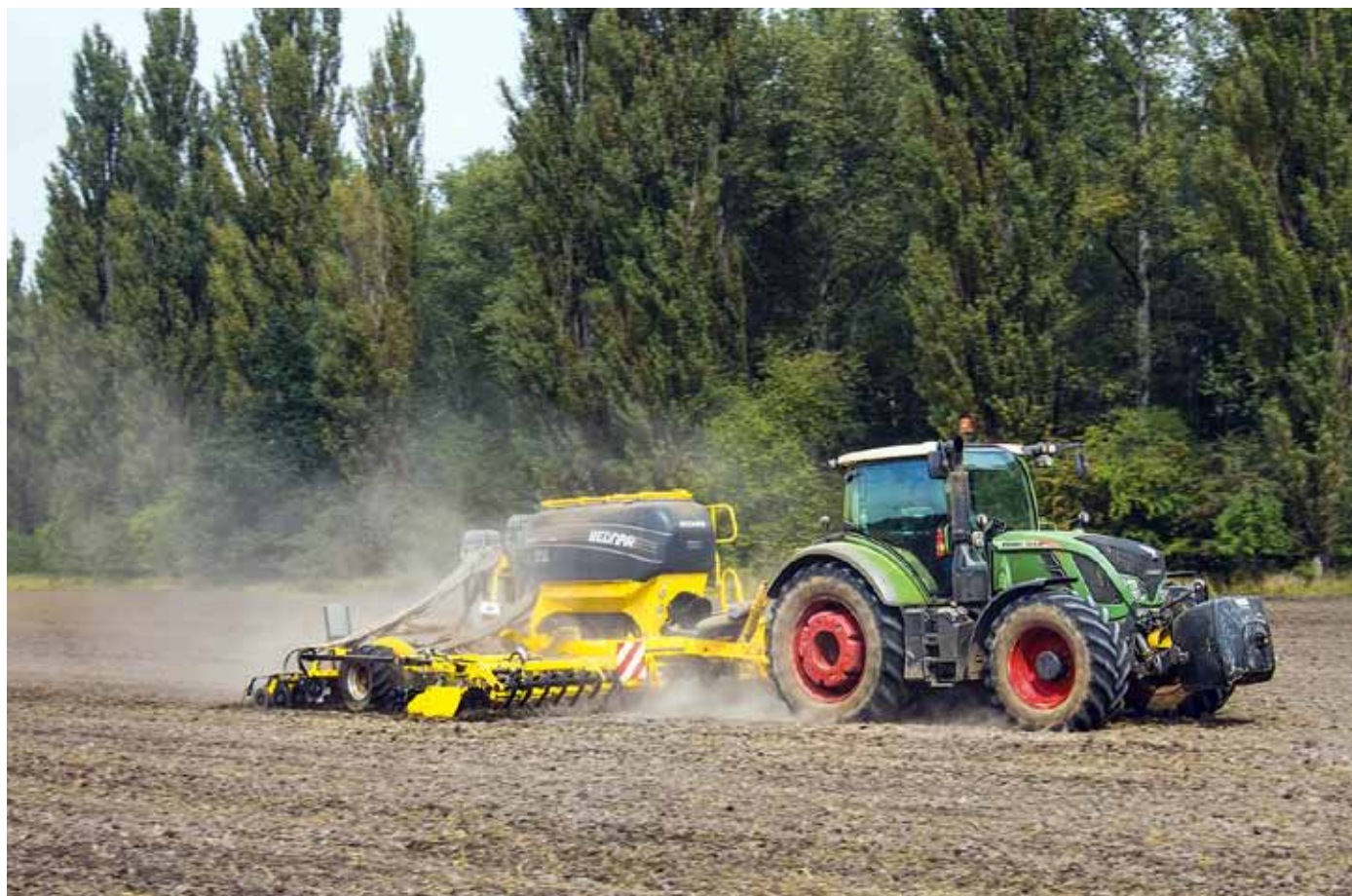
Secí stroj OMEGA OO 6000 L v ZOD »Bratraců Veverkových« Živance seje ozimý ječmen bez využitím zásobníku na hnojivo FERTI-BOX FB 2000 F.
